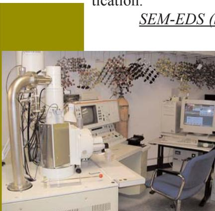
Fig. 20 SEM-EDS instrument
